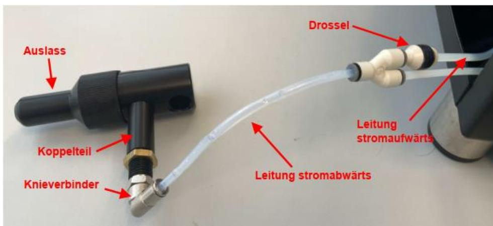
Unter Berücksichtigung des Leitungsbereichs im Knieverbinder ergibt sich eine Streckenlänge mit erweitertem Durchmesser stromabwärts der Drosseleinrichtung von etwa 10 cm, wie in der folgenden Abbildung demonstriert wird (Hinweis: Bezugszeichen und Längenbestimmung sind von der Antragstellerin eingefügt worden):
